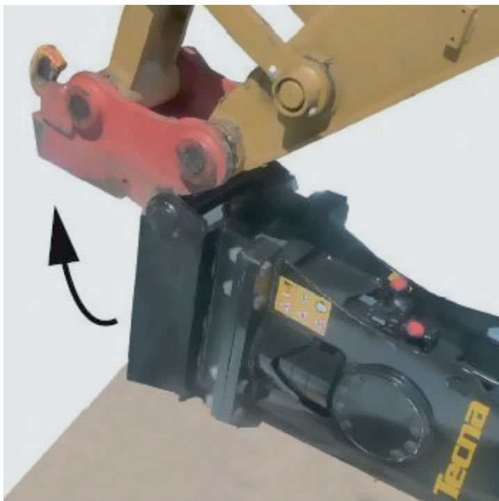
ABBILDUNG 22: Verbindung zum Schnellwechsler lösen (Schritt 1)
